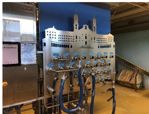
Der weisse Saft beginnt den Weg durch ein automatisiertes Labyrinth von Rohren, Ventilen und Hahnen bis zur Dicklegung.
