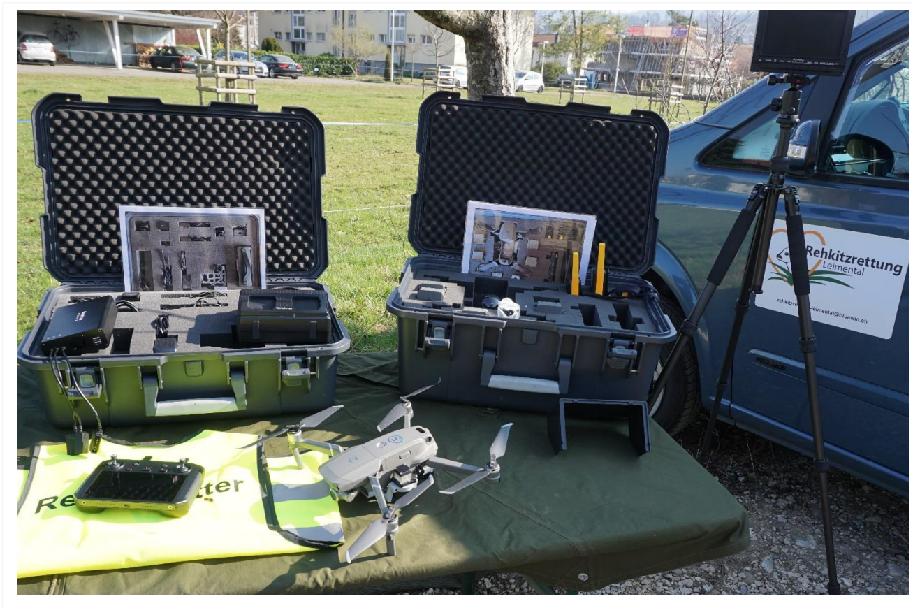
Ausrüstung (Drohne mit Kamera, Steuergerät, Bildschirm und Akkus)
